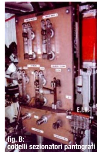
fig. B: coltelli sezionatori pantografi
