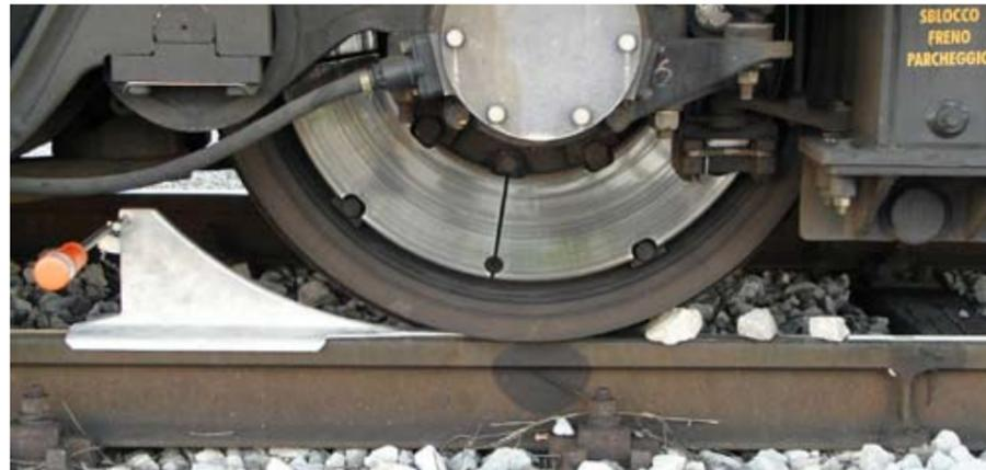
Staffe e pietrisco a confronto: un esempio dell'applicazione del principio della "massima sicurezza tecnologicamente possibile" contenuto nell'art.2087 del codice civile
