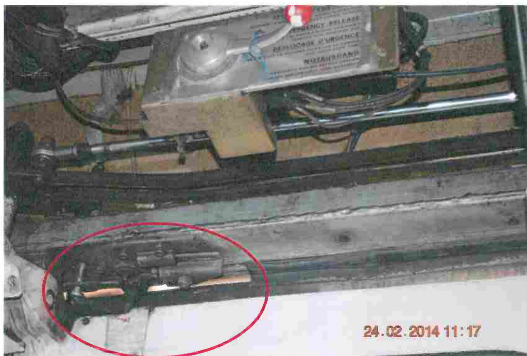
Figura 25 - Mancanza guarnizione (Foto Polizia Scientifica)
