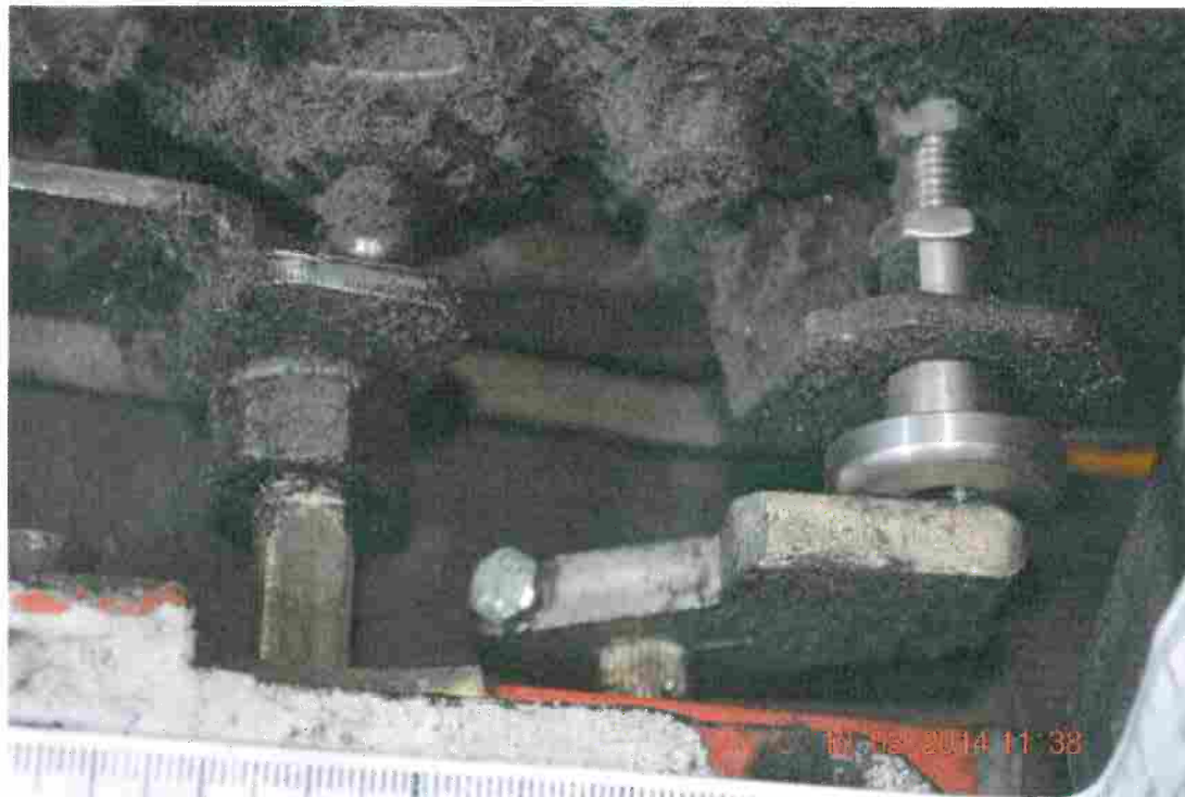
Figura 33 - Sporcizia nei meccanismi (Foto Polizia Scientifica)
