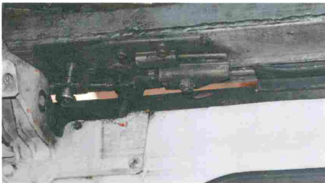
Figura 26 - Particolare mancanza guarnizione (Foto polizia Scientifica)
