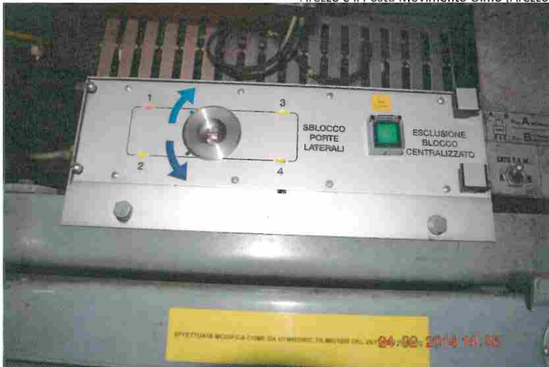
Figura 24 - Centralina di lateralizzazione recante indicazione porta 1 aperta (foto Polizia Scientifica)
