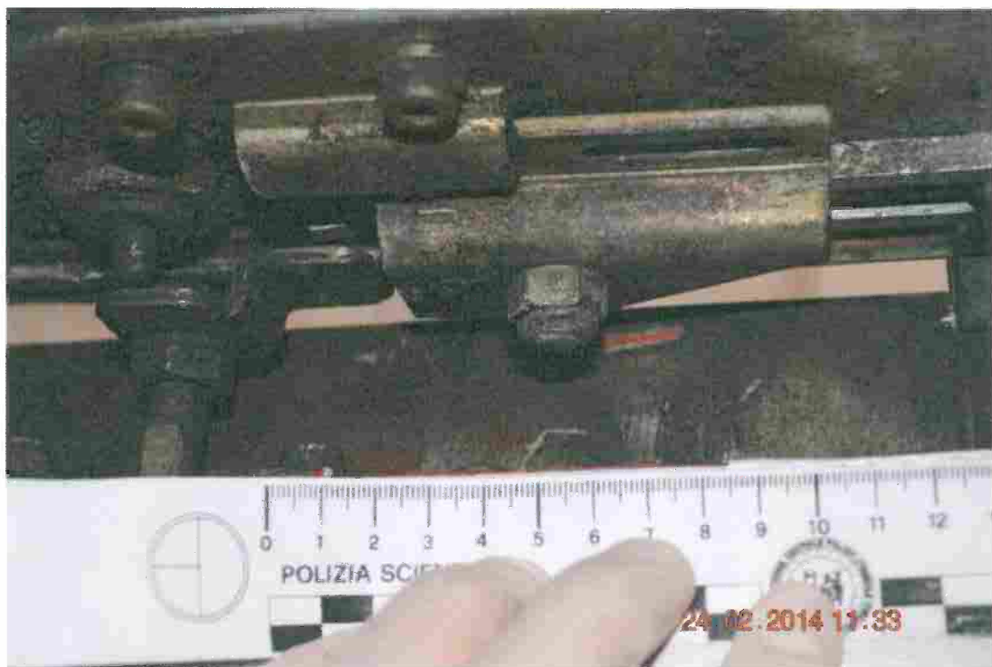
Figura 28 - Meccanismi sporchi e "impastati" (Foto Polizia Scientifica)
