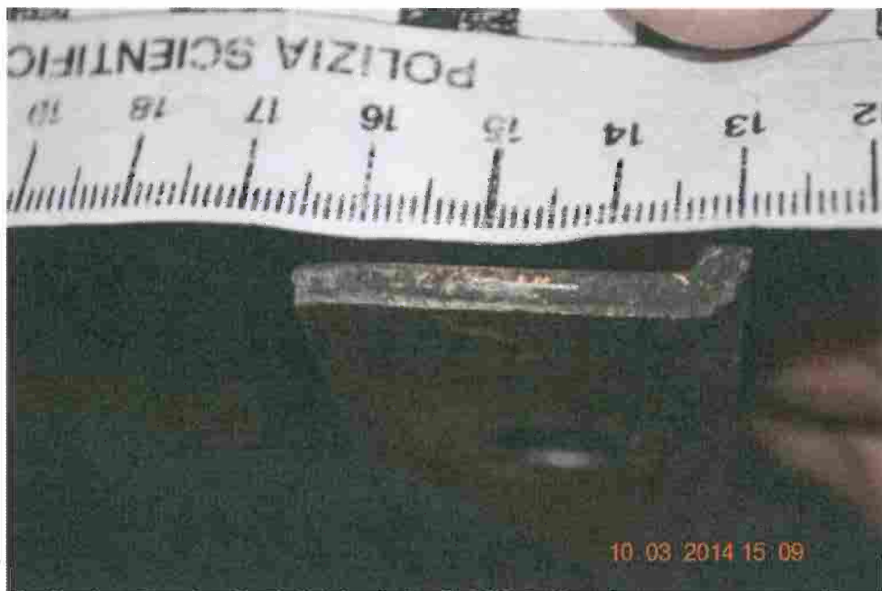
Figura 42 - chiavistello - particolare impuntamento (Foto Polizia Scientifica)
