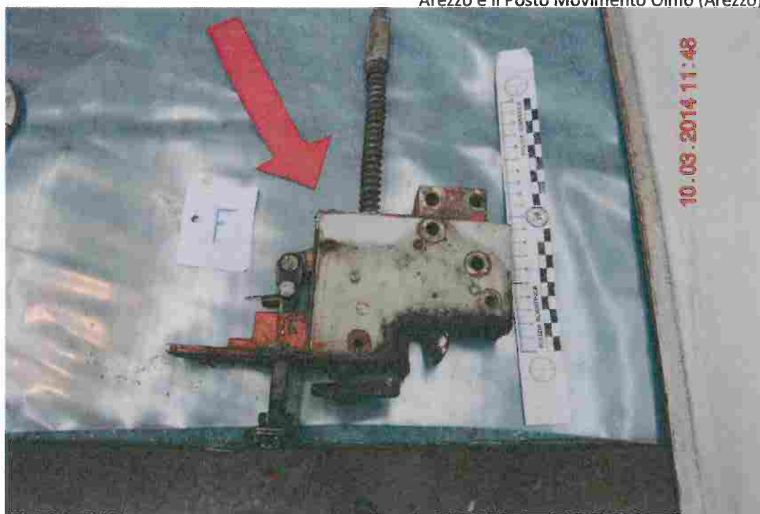
Figura 36 - Complesso chiavistello smontato (Foto Polizia Scientifica)
