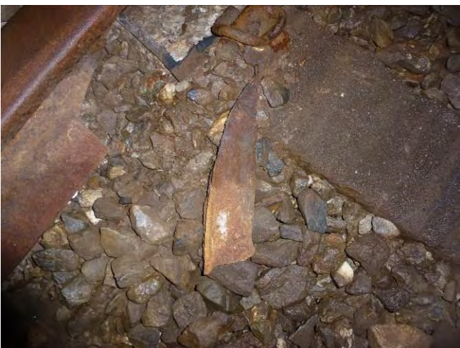
Figura 39 –Frammento di rotaia rotta (4)
