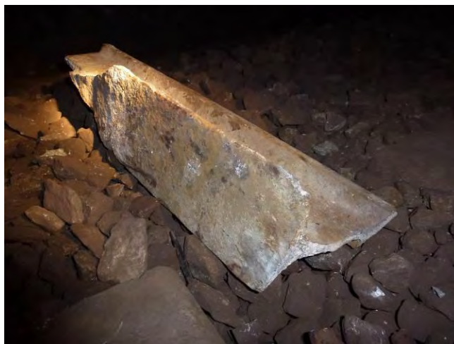
Figura 56 - Parte della rotaia rotta (7)
