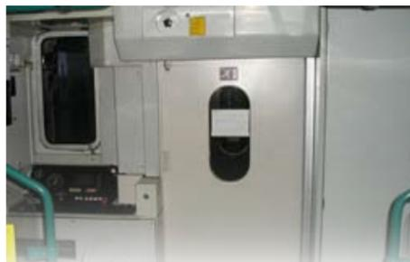
Il banchino di manovra della Loc. 464: la visibilità lato guida è già estremamente ridotta ma è inesistente sul lato di destra non essendo presente nemmeno il vetro
