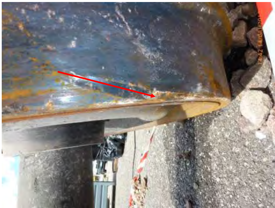
Figura 26 – sala B lato B (segno sulla ruota DX del IV assile)
